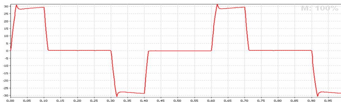
Рисунок 2. График величины магнитного поля в рабочей зоне экспериментального устройства в режиме 3. По оси абсцисс – продолжительность периодов импульс/покой (по 100 мс), по оси ординат – сила тока (А).
